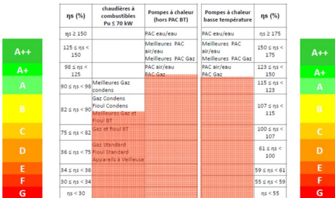
Figure 2 : Etiquettes énergétiques en fonction des types de générateurs de chaleur
