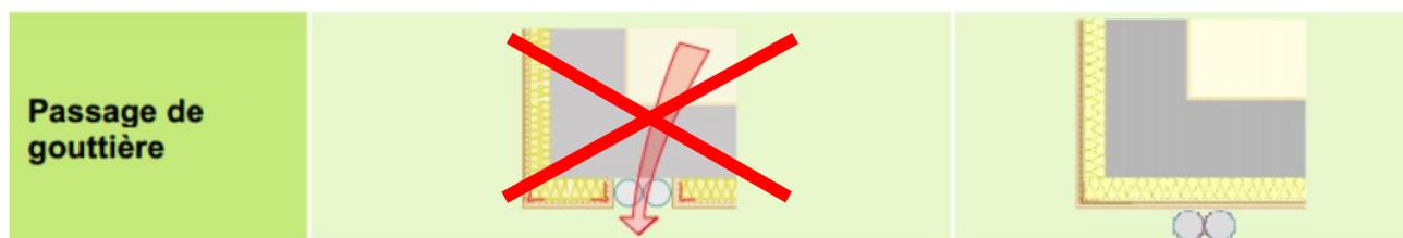
Figure 1 : Règle de traitement des passages de gouttière
