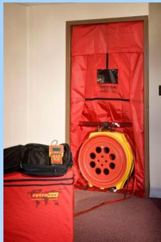
2 – La qualité de l'enveloppe à la **perméabilité à l'air** est un élément **ESSENTIEL** de la réussite. Une bonne isolation sans une bonne perméabilité conduit à une performance médiocre. La qualité de la perméabilité a autant d'impact que celle de l'isolation. **Gain de 3,5 kWh/m<sup>2</sup>/an/(vol/h de n<sub>50</sub>)**.
